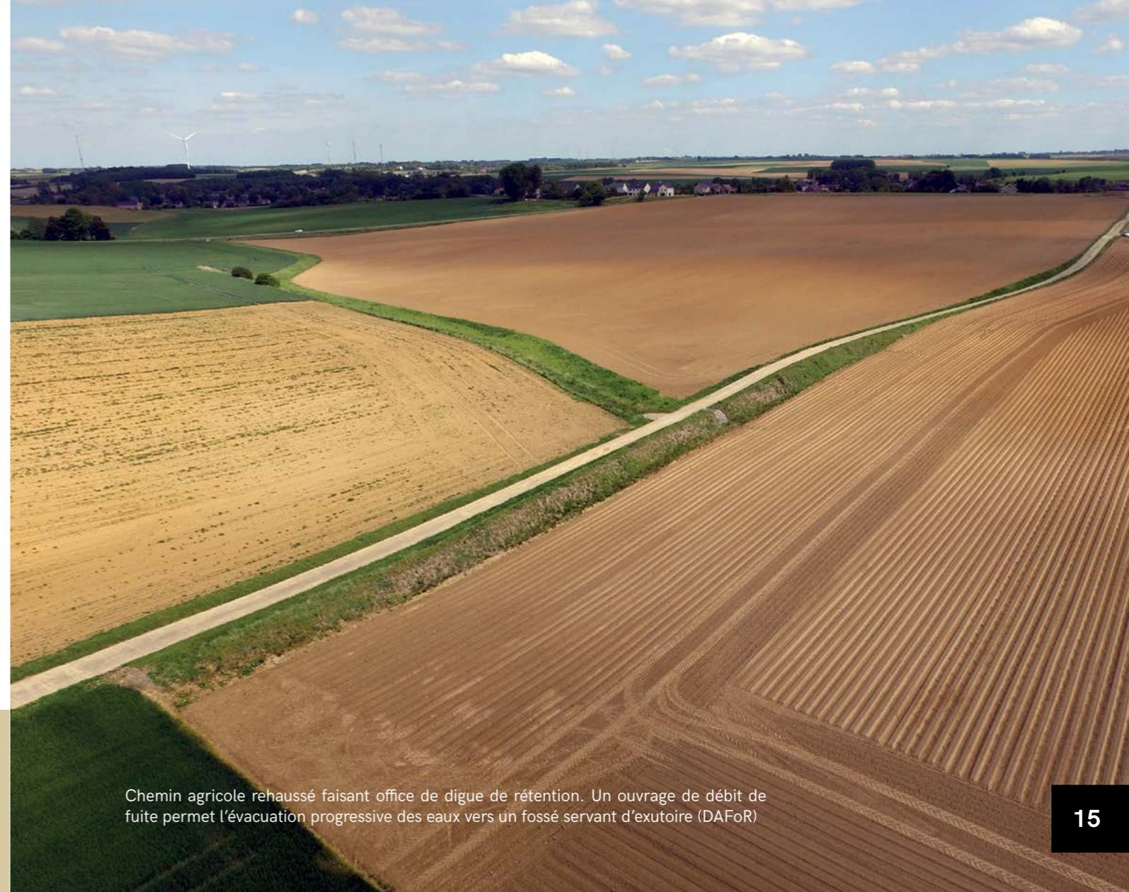
Chemin agricole rehaussé faisant office de digue de rétention. Un ouvrage de débit de fuite permet l'évacuation progressive des eaux vers un fossé servant d'exutoire (DAFoR)
