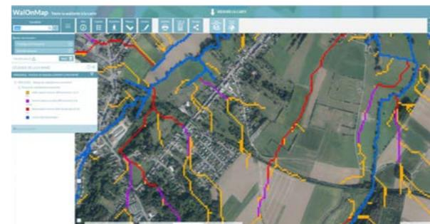
La carte LIDAXES tient autant que possible compte de ces éléments artificiels pouvant dévier en temps normal le tracé des eaux de ruissellement. Dans les faits, en cas de précipitations intenses entraînant une potentielle saturation des fossés et avaloirs, il arrive que les eaux de ruissellement
