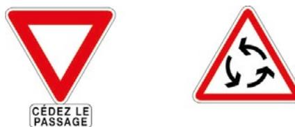
Figure 4.20 – Panneaux de pré-signalisation et de signalisation d'un giratoire.
