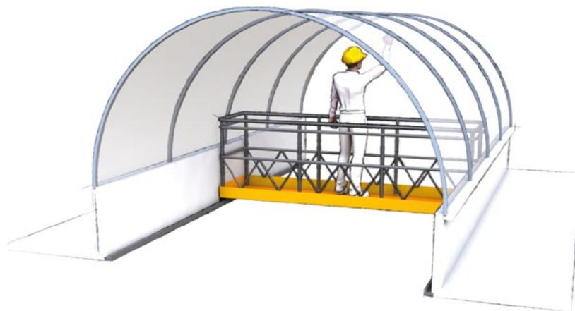
Figure 7.4 – Protection intégrée avec passerelle roulante.
