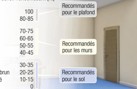
Figure 5.7 – Exemples de pouvoir réfléchissant des couleurs et matériaux et recommandation de zones d'utilisation.
