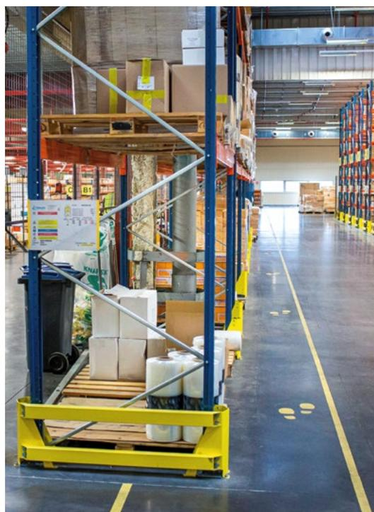
Photo 8.1 – Exemple de racks aménagés sur le plan de la sécurité : plancher de positionnement et butées de pied d'échelle.
