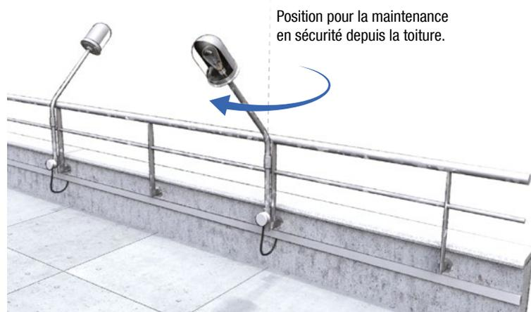
Figure 5.11 – Principe de luminaire pivotant pour le remplacement d'ampoule.
