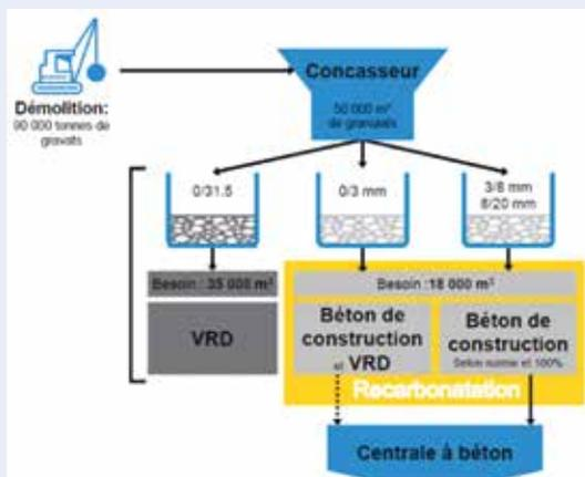
**Le béton est déferrailé puis broyé sur place pour être réutilisé**
